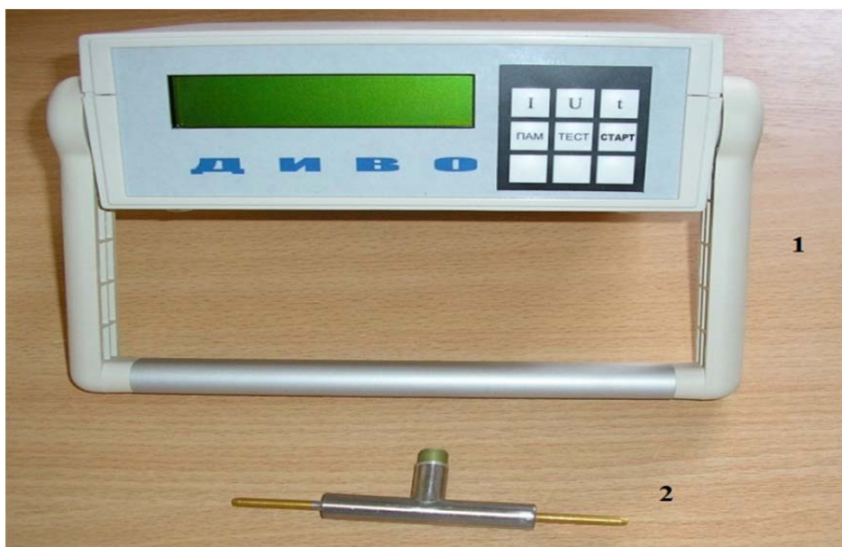
Рисунок 4 – Джоульметрический прибор «Диво» (1) и проточный электрод (2), используемые для экспресс-диагностики анаэробной инфекции у больных острым парапроктитом
